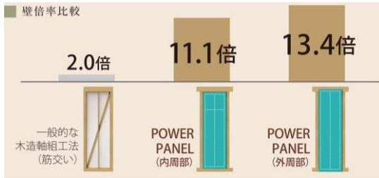
耐力壁の強度は「壁倍率」で表されます。一般的な在来工法の筋交い耐力壁の壁倍率 2.0 倍に対し、「パワーパネル」は内周部 **11.1 倍**、外周部 **13.4 倍** を実現。
